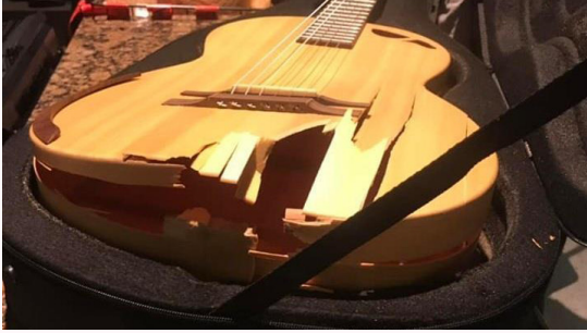
ตัวอย่างความเสียหายจากการส่งกีตาร์ลงใต้ท้องเครื่อง (ไม้หน้าแตก)
