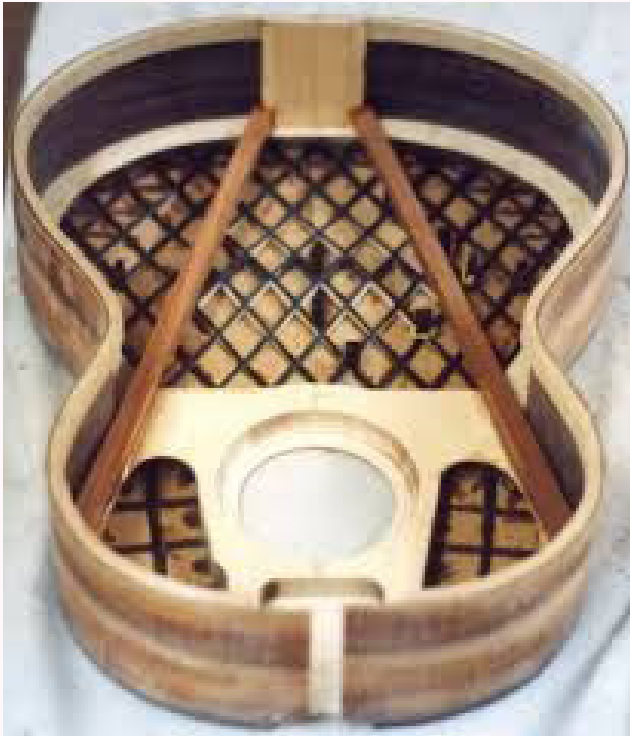
ด้านในของกีตาร์ Greg Smallman แบบ Lattice Bracing
